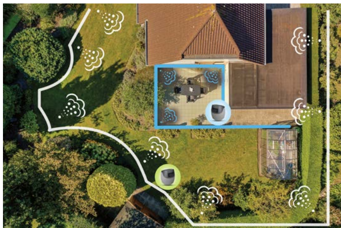
FIG. 1 linea bianca indica la posizione degli ugelli atomizzatori suggerita per l'utilizzo di insetticidi mentre la linea blu indica la posizione consigliata per i repellenti
